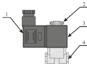
Рисунок 9. Пневмоклапан
