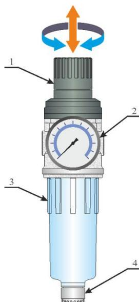
Рисунок 7. Блок подготовки воздуха
