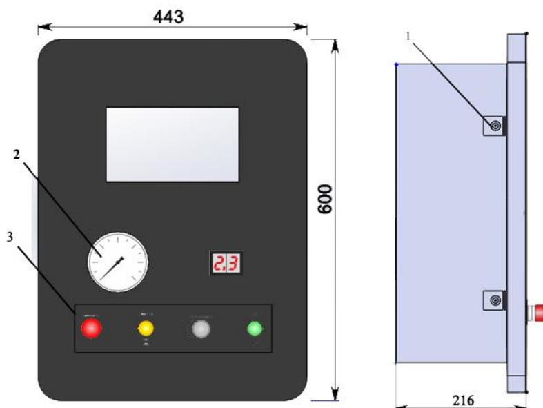
Рисунок 3. Пневмоавтомат, внешний вид
