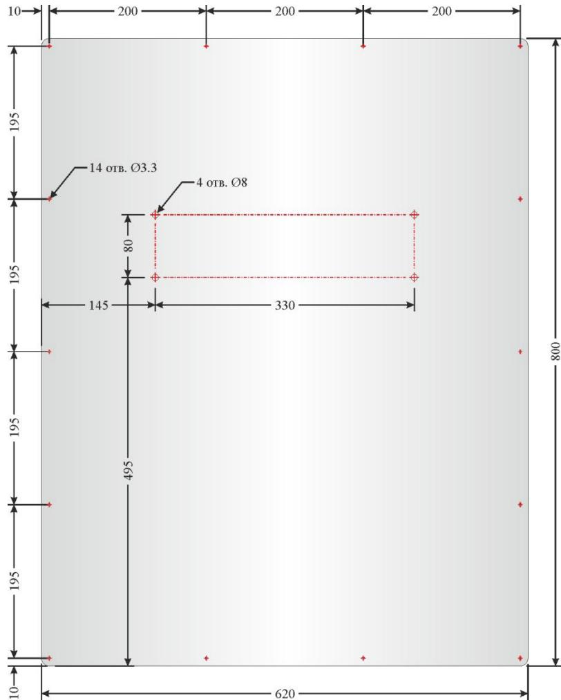
Рисунок 12. Лист защитный, габаритные размеры и монтажные отверстия
