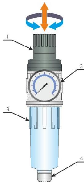
Рисунок 7. Блок подготовки воздуха
